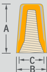
Conector para cable, interior metálico. S-P1
